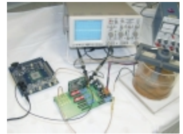
Demonstrationsaufbau des THE-Systems mit ebenfalls am IPE entwickelter Low-Noise-Verstärker-/Multiplexer-Einheit für Ultraschallwandler im NDT-Bereich
