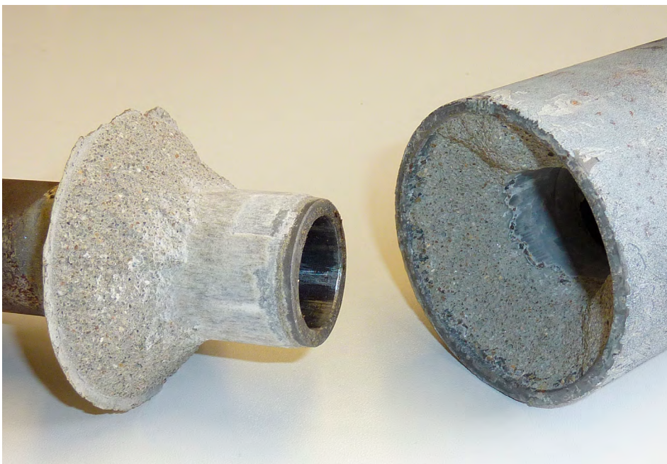
Bruchbild von zwei Hohlprofilen (Durchmesser 34 mm bzw. 76 mm), die mit der neuen Hybridklebtechnik (Klebspaltdicke 20 mm / Überlappungslänge 45 mm) verbunden wurden. Diese Verbindung erfüllt höchste Tragfähigkeitsanforderungen (statische Traglast 110 kN) und kann auch größere Toleranzen der Fügeteile ausgleichen.
