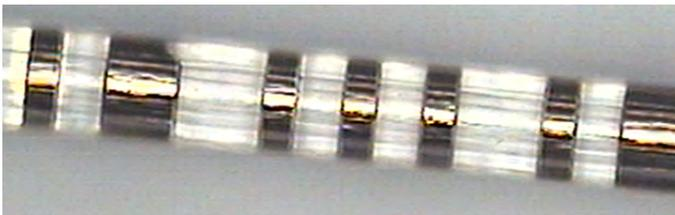
Detailaufnahme des Kunststofffadens mit einer rundum gut sichtbaren Barcodestruktur aus Gold.
