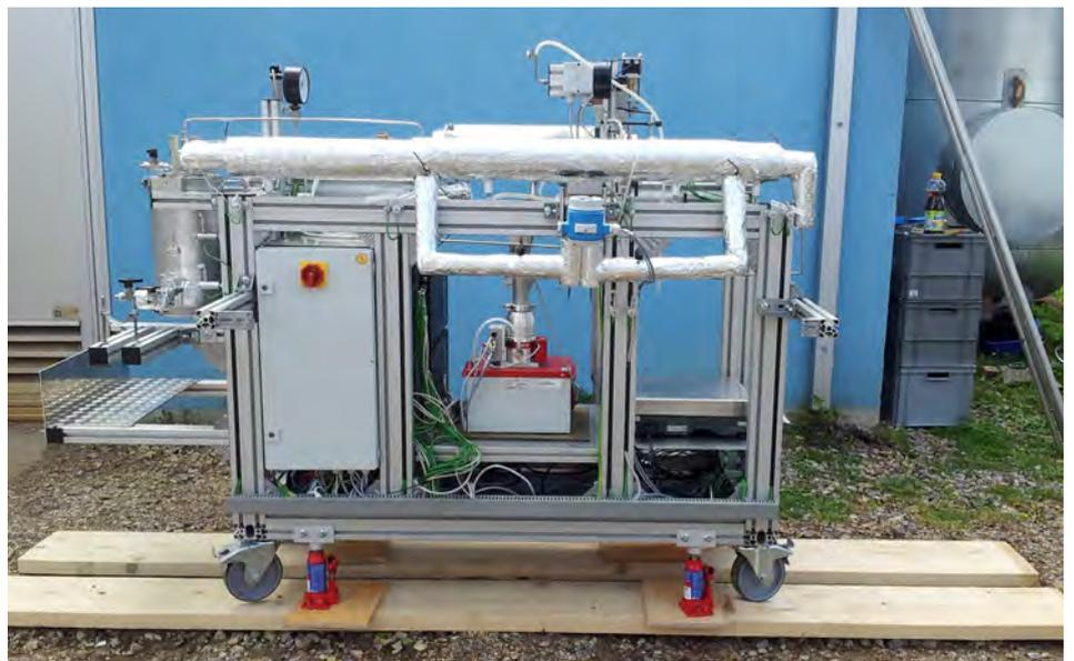
Im Labor am IKET können Bedingungen verschiedener Geothermiekraftwerke simuliert werden. Am erweiterten Messstand werden spezifische Wärmekapazität, Viskosität und Dichte des Thermalwassers bestimmt.
