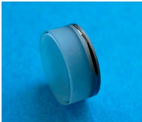
Ein Glasgehäuse samt Deckel wurde prototypisch mit der neuen Fügetechnik hermetisch dicht verschlossen. Die Klebefuge besteht aus Klebstoff und ist mit Titan besputtert.
