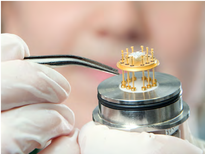
Ein beheizbarer Sensor mit unterschiedlich beschichteten Mikrochips detektiert eine Vielzahl toxischer Gase und misst deren Konzentration kontinuierlich. © Tobias Schwerdt
