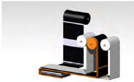
Die Zickzack-Faltung mit speziell beschichteten und zueinander ausgerichteten Materialbahnen wird automatisiert bis zur gewünschten Stapelhöhe durchgeführt.
