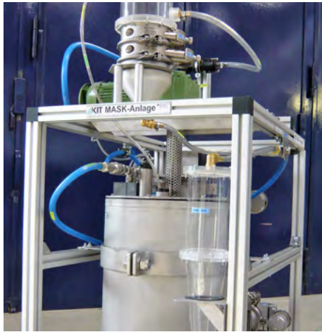
Am Institut wurde eine prototypische Anlage des Magnetseparationsverfahrens realisiert. Neben der Separation der Stahlpartikel wird das verwendete Schneidemittel wiedergewonnen und recycelt.
