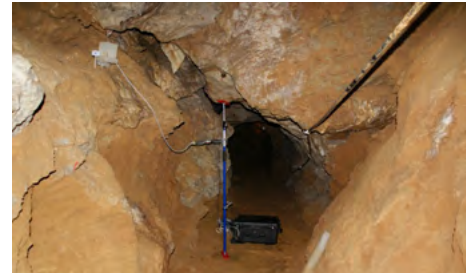
In einer Höhle werden regelmäßig Tropfwasser-Beprobungen mit dem Probensammler des KIT durchgeführt.
