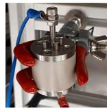
**Testzelle für Feststoffbatterien**
